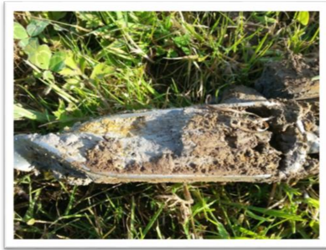
Photo 100 - Exemples de carottes avec des traits rédoxiques (à gauche) et des traits réductiques (à droite)
